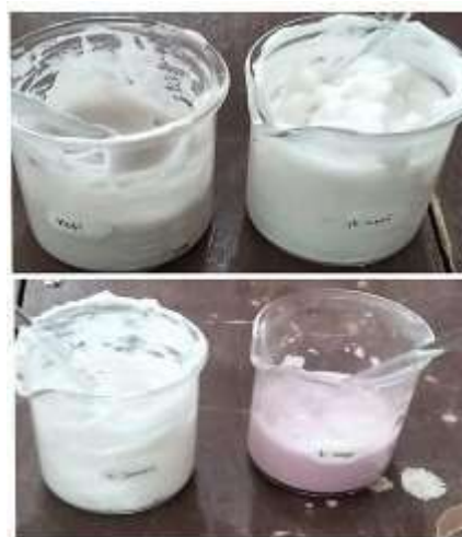
Gambar 2. Dokumentasi Uji Busa
