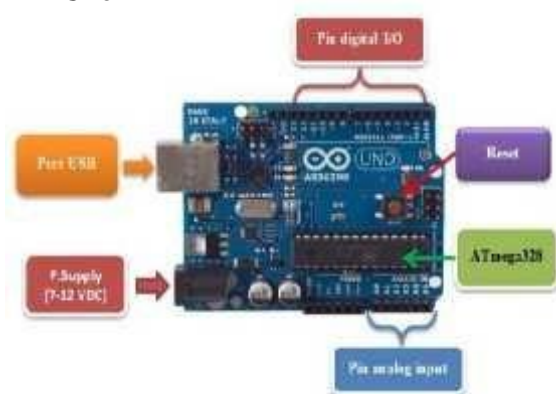
Gambar 2.2 Bagian Utama Arduino Uno Board (Yusro,2016:10)
