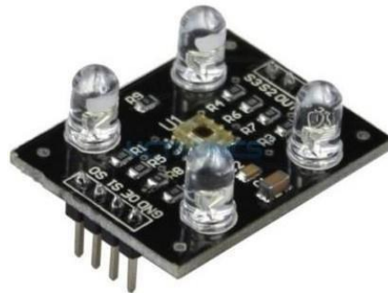
Gambar 2.6 Bentuk Fisik TCS3200
