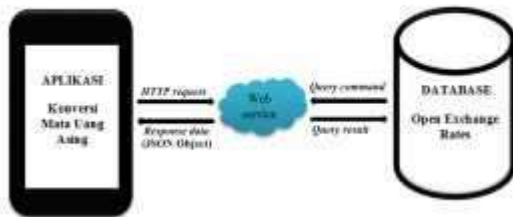
Gambar 3.7 Diagram Kerangka Kerja Aplikasi
