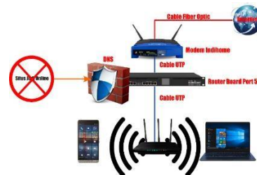
Gambar 7. Topologi Penerapan Metode DNS Blocking pada Winbox Mikrotik Router OS V6.48.3 di Routerboard RB 301 Ui AS-RM
