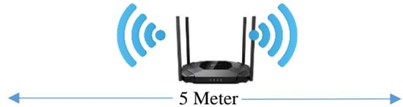
**Gambar 10.** Skenario Pengujian Coverage area Dalam Kondisi *Interferensi*
