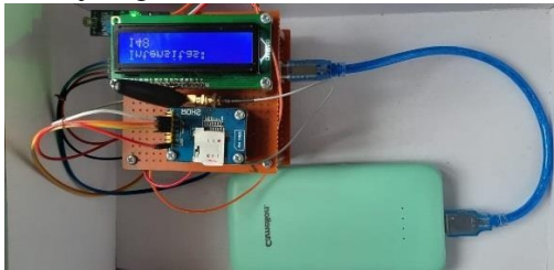
Gambar 5 Pengujian Sensor LDR dan tampilan LCD
