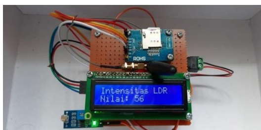
Gambar 1 Alat pendeteksi intensitas cahaya
